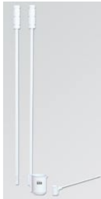
Черпак объёмом 10 мл снабжен штоком фиксированной
