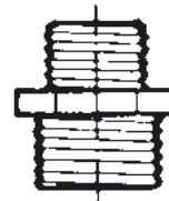
Штуцер редукционный с внешней резьбой.
