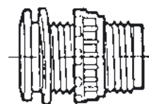
Соединительный узел для монтажа на ёмкость, внешняя резьба, в комплекте с уплотнениями из ЭПДМ. Предназначен для упрощения монтажа резьбовых соединений на ёмкость.
