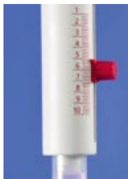
Дозатор переменного объёма для бутылей
