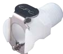
Быстроразъёмные соединения (гнездового типа), ном. \varnothing отверстия 3,2 мм, соединение для трубок с внешней резьбой
