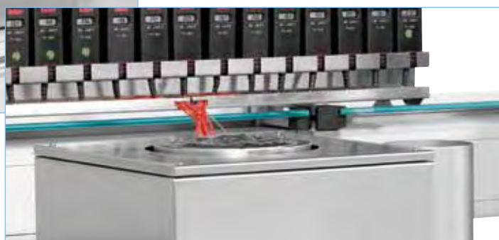
Cal 700 – калибровочная ванна для измерительных и контрольных датчиков
