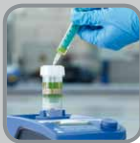
ШАГ 9 При необходимости пробу можно извлечь при помощи шприца через проницаемую мембрану пробирки.
