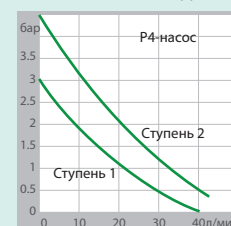
Мощность насоса P4 Теплоноситель: вода
