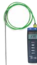
Термометр для RAKU 100, простой в обслуживании, температурный датчик NiCr-Ni, диапазон индикации 20 - 1200 °C, возможность подключения второго датчика с функцией переключения индикации
