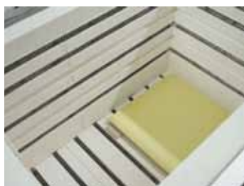
Камера обжига с 5-сторонним нагревом
