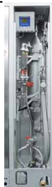
Система очистки технологических газов методом промывки
