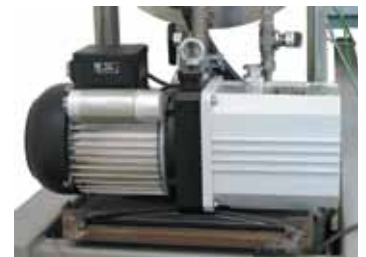
Вакуумный насос для холодного вакуумирования реторты
