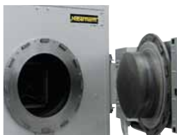
Быстроразъемное байонетное соединение для реторты, также с электрическим приводом в качестве дополнительного оборудования
