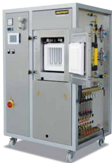
VNT 8/22-KE с волокнистой изоляцией и нагревательными элементами из дисилицида молибдена
