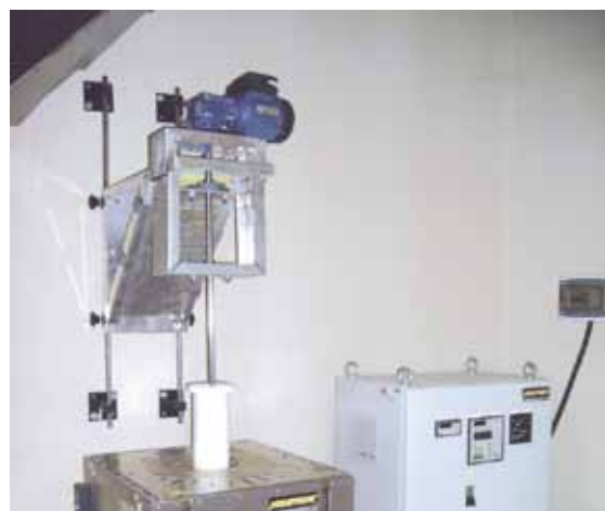
RHTV 120/300/15 встраивается в механизм поперечной подачи
